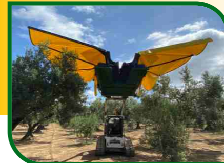
Ombrello dal diametro di 5 o 6 m Reverse umbrella of 5 or 6 m diameter
