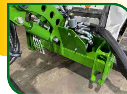
Castelletto di aggancio alla piastra della minipala Connection plate to the skid steer loader
