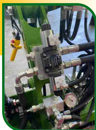
Valvola per la regolazione del serraggio della pinza Electric controls in the cabin
