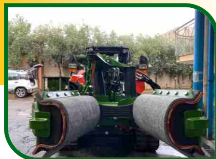
Apertura della pinza fino a 55 cm con rulli in gomma a mescola esclusiva Max opening of the pliers of 55 cm with exclusive mixture rubber pillows
